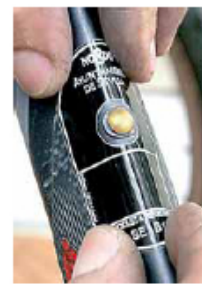
Tornillo instalado en el cuadro.
